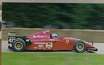
El 3.5 V12 E4A-94 Tipo043 de 1994 propulsaba al Ferrari F412T con 850 CV
