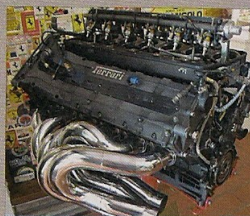
El 3.5 V12 E4A-94 Tipo043 de 1994 propulsaba al Ferrari F412T con 850 CV
