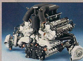
El 1.5 TAG Porsche TTE PO1 del McLaren MP4/3 de 1987 daba 1.100 CV
